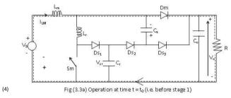
**Stage 1:**  $t_0 \le t \le t_1$
